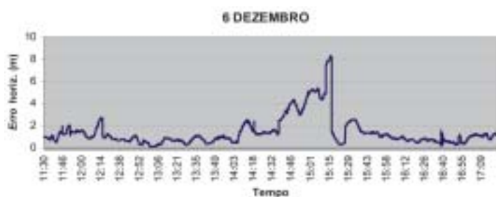
Gráfico 4 – Evolução dos erros do DGPS no plano horizontal em 6 de Dezembro
