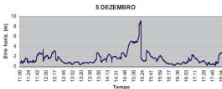
Gráfico 3 – Evolução dos erros do DGPS no plano horizontal em 5 de Dezembro
