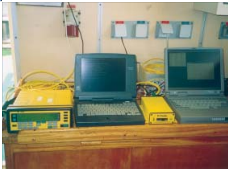
Fig. 3 – Computadores gravando dados do receptor GPS geodésico (Trimble 4000 SSE – equipamento amarelo à esquerda) e do receptor DGPS (Trimble DSM 212 – equipamento amarelo à direita)
