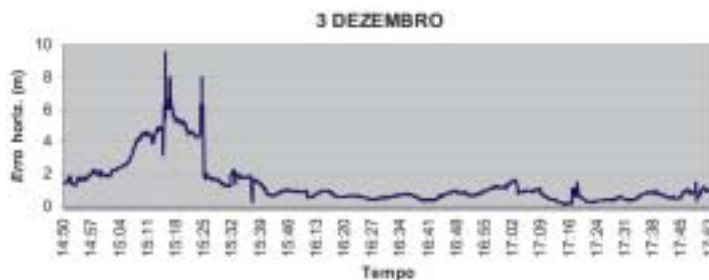
Gráfico 2 – Evolução dos erros do DGPS no plano horizontal em 3 de Dezembro
