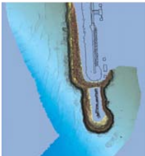
Modelo tridimensional do fundo do molhe oeste de Sines
