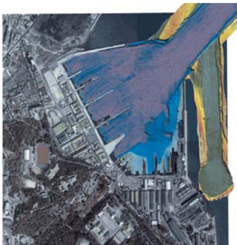
Fotografia aérea integrada com o modelo tridimensional obtido dos dados multifeixe
