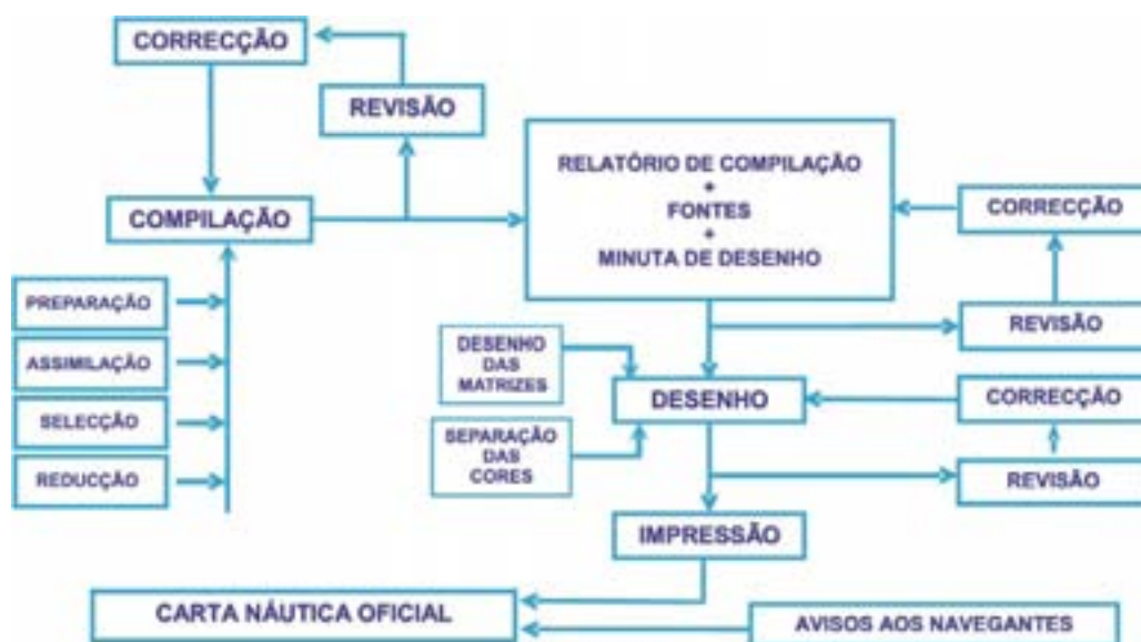
Figura 7 – Construção de uma CNO
