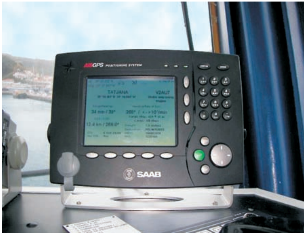
Figura 1 – Equipamento AIS de bordo
