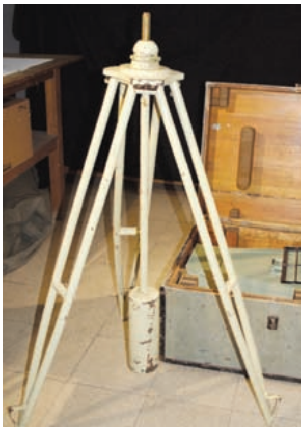
Figura 3 – Tripé com sistema cardan para manter a horizontalidade. A câmara é uma PANORAMA da Zeiss do início dos anos 20
