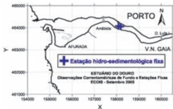
Figura 1 – Posicionamento das observações da estação fixa hidro-sedimentológica, realizadas no estuário do rio Douro durante a campanha ECOIS 2005-09/10 e ECOIS 2006-02/03.
