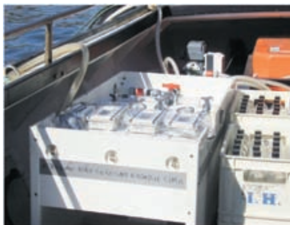
Figura 4 – Sistema de filtração directa de sedimentos em suspensão e colheita de água a bordo da embarcação Boa Nova durante as observações na estação fixa hidro-sedimentológica do estuário do rio Douro.
