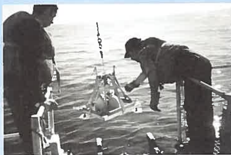
Recolha de sedimentos com o colhedor Smith McIntyre.
