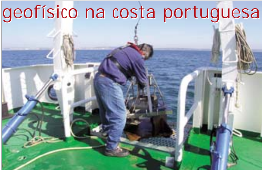
Preparação da draga SMT utilizada na colheita de amostras superficiais de sedimentos a bordo do NRP Auriga
