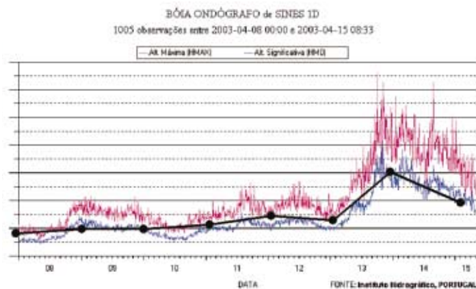
Fig. 4 – Gráfico da bóia ondógrafo de Sines com sobreposição da previsão realizada na Pré-Sail Conference
