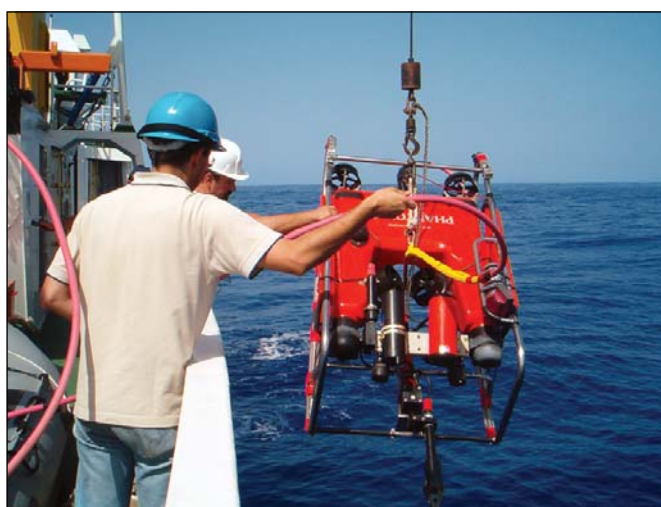
Colocação do ROV na água
