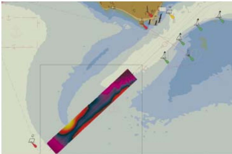
Imagem da área do levantamento hidrográfico. A amarelo e a vermelho estão representados os fundos inferiores a 14 m, sendo visível, por comparação com dados de trabalhos anteriores, o aproximar ao Enfiamento do baixo conhecido como Cabeço do Pato
