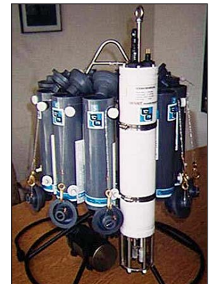
Sonda multiparâmetro Idronaut instalado em sistema automático de recolha de águas (Rosette)
