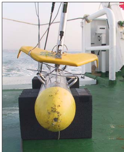
Aspecto do sonar lateral após a difícil missão das Q - ROUTES
