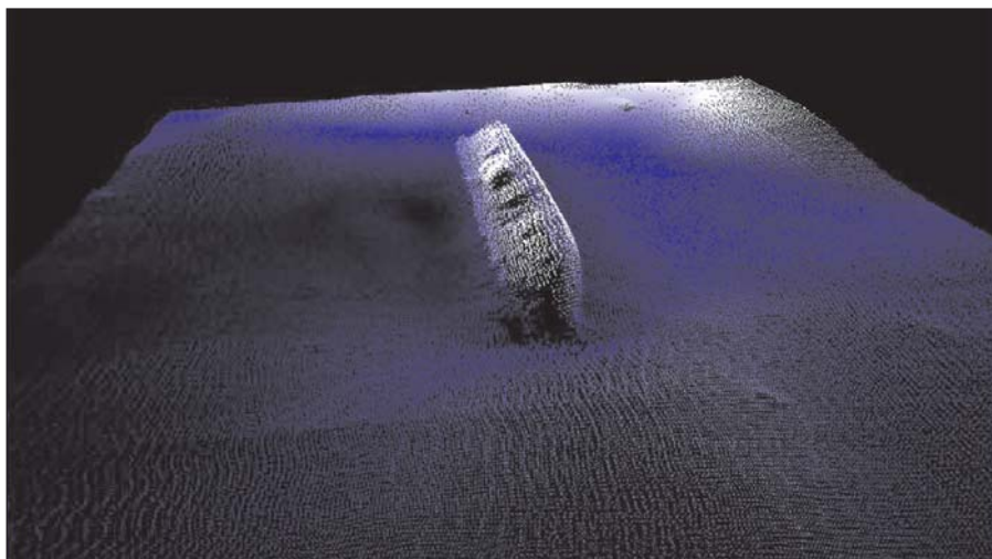
Navio naufragado no rio Tejo, detectado com sondador multi-feixe
