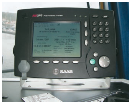
Fig. 1 – Equipamento AIS de bordo
