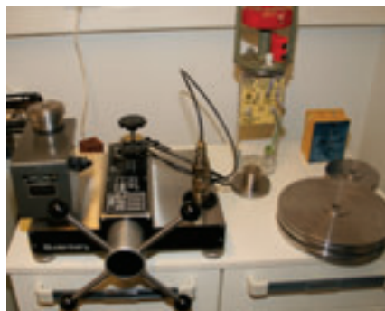
Balança Manométrica Buddenberg para calibração de sensores de pressão.
