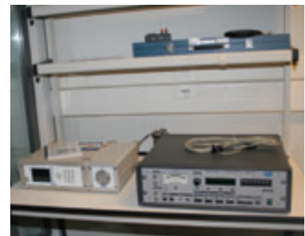
Padrão de Temperatura e Humidade Relativa para ensaios climáticos.
