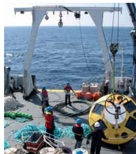
Fig.3 - Aspeto da tolda do NRP Almirante Gago Coutinho no início da operação de colocação na água da boia profunda MONICAN1, em abril de 2011. É visível o conjunto de cabos, poitas e flutuadores que irá permitir manter esta boia fundeada numa posição com profundidade de cerca de 2000 metros
