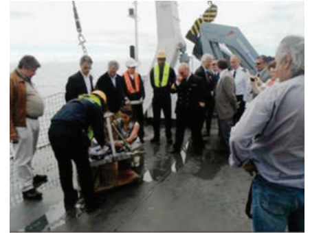
Recolha de amostras de sedimentos com a draga Smith-McIntyre
