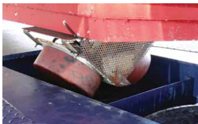
Duplo transdutor do sondador multifeixe utilizado na embarcação de sondagem "Gaivota".
