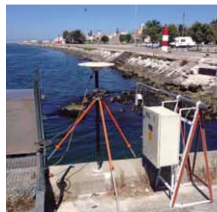
Coordenação de um ponto de apoio e observação de leituras de maré com um marégrafo RADAR.
