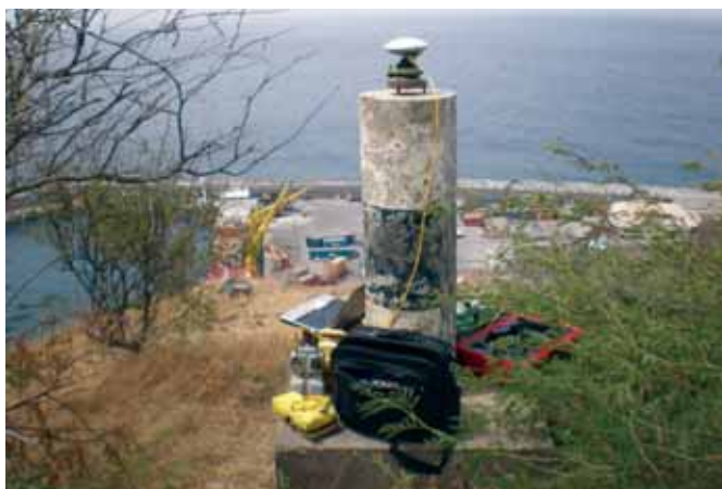
Observações GNSS num vértice geodésico (Vale de Cavaleiros)
