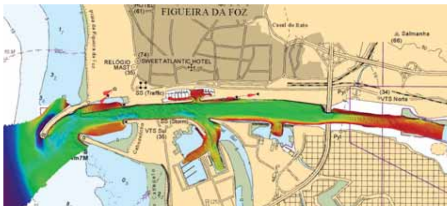
Cobertura batimétrica realizada com o sondador multifeixe.
