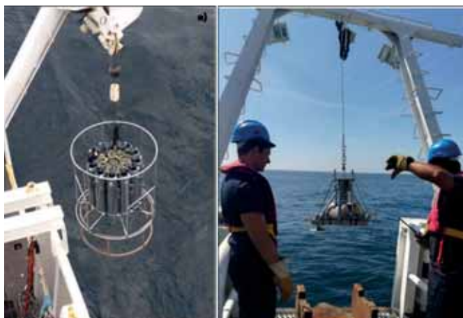
Figura 2 – (a) Sistema Rosette equipado com CTD e garrafas Niskin (amostragem de águas); (b) draga tipo Smith-McIntyre (amostragem sedimentar).
