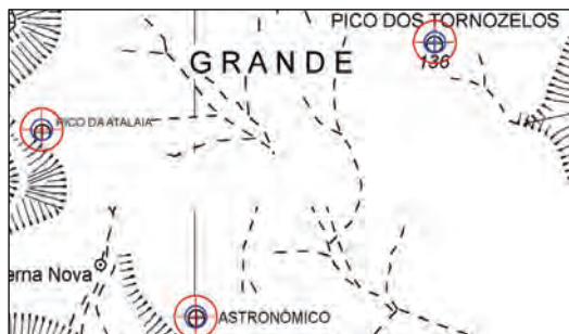
Figura 2 – Transformação resultante da hipótese Datum Astronómico – elipsóide Clarke66. Símbolos a azul e preto resultantes da transformação. Símbolos a vermelho implantados em coordenadas geodésicas WGS84 resultantes das observações de 2009.
