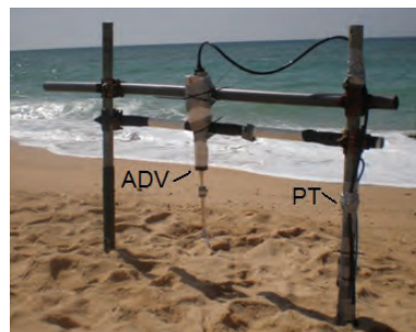
Fig. 1. ADV, PT (transdutor de pressão) e estrutura de instalação na Praia de Faro
