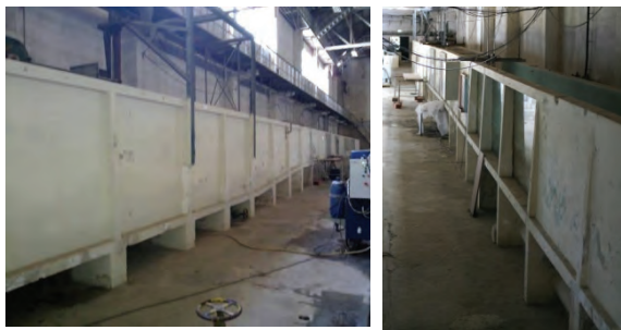
Fig. 2. Vistas do canal de ondas utilizado nos ensaios experimentais.
