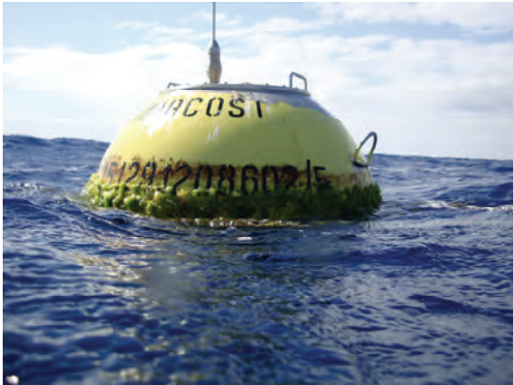
Fig. 4- Boia ondógrafo, Datawell MKIII.
