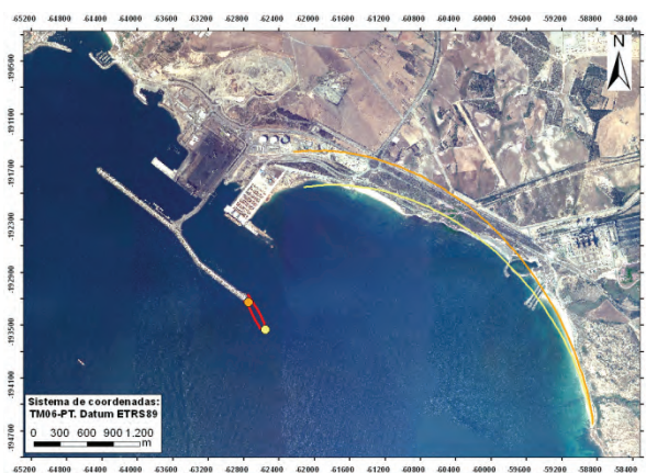
Fig. 6 – Ajuste da configuração parabólica (a laranja) com o ponto de difração (a laranja) nas imediações da ponta do molhe Leste (ampliação 1). A amarelo encontra-se igualmente o ajuste da configuração parabólica com o ponto de difração (a amarelo) nas imediações da ponta do molhe Leste (ampliação 2), esta ampliação encontra-se em execução e é representada a vermelho na figura.
