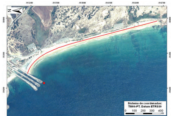
Fig. 7 – Ajuste da configuração parabólica (a vermelho) com o ponto de difração (a vermelho) nas imediações dos molhes da central termoelétrica.
