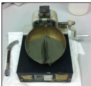
Fig. 2 – Concha de Casagrande utilizada nos ensaios.
