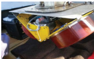
Figura 1 – transdutores instalados na coluna da UAM Fisália.
