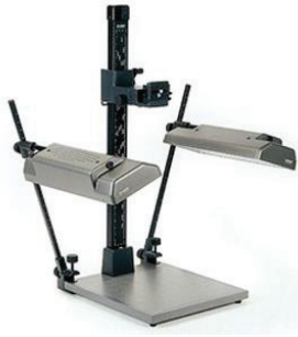
Fig. 3. Suporte da Kaiser utilizado para fixar a altura da máquina fotográfica ao longo do trabalho e respectiva estrutura de iluminação da mesa, onde o perfil será fotografado.
