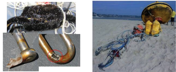
Fig. 3. Imagens de corrosão de materiais em aço, excesso de incrustação biológica e derivas das boias por tempestades ou intervenções humanas.
