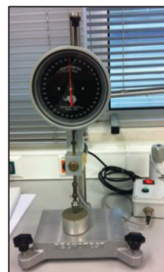
Fig. 3 – Cone penetrómetro utilizado nos ensaios.
