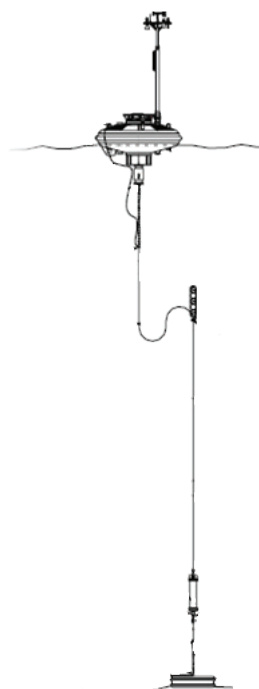
Fig. 2. Esquema de amarração simples em forma de S utilizada nas boias multiparamétricas (User manual Wavescan buoy, 2009).
