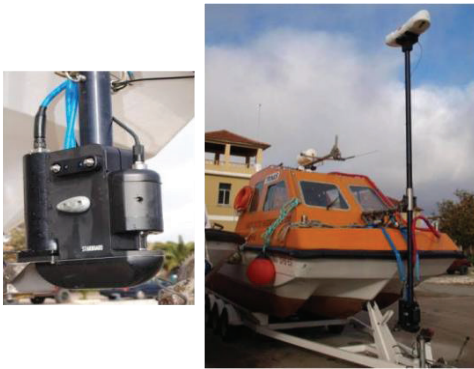
Fig. 4 - GS500+C equipando a embarcação de sondagem Trinas, numa montagem à proa
