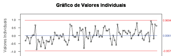
Figura 4 – Gráfico de valores individuais sob controlo, após remoção de causas especiais.
