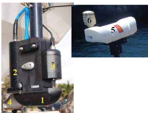
Figura 2 – Sistema GS500+ com transdutores dual head (1), sensor inercial (2), sensor de medição VPS (3), transdutor SFS (4), 2 antenas GPS para determinação da proa (5) e antena GPS para determinação da posição (6)
