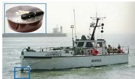
Fig. 1 Sistema multifeixe EM2040C montado na embarcação de sondagem UAM 'Atlanta'
