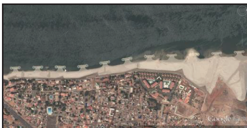
Fig. 7. Alternativa selecionada para a contenção e estabilização da Praia da Nicha – vista em planta - simulação.
