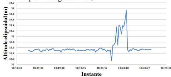
Fig. 6. Datagrama da altitude elipsoidal da antena GNSS correspondente a uma elevada diferença entre os MB (falha no posicionamento GNSS RTK).
