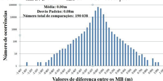
Fig. 5. Distribuição estatística das diferenças, em metros, entre o MB_{\text{MLS-DV-E}} e o MB_{\text{maré}} de 2m de resolução.
