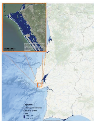
Fig. 4. Cenário de inundação em 2100, com o modelo de maré mais SM com período de retorno de 50 anos para 0.25% de submersão. Zoom feito para a zona da Costa da Caparica.
