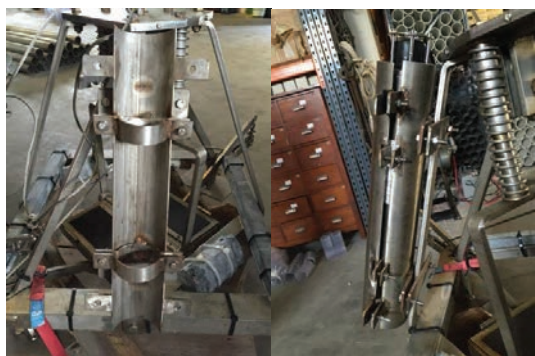
Fig. 2. Fotografia da parte da estrutura fixa ao braço da draga à esquerda, e à direita a mesma com o transponder e a restante parte da estrutura montada.
