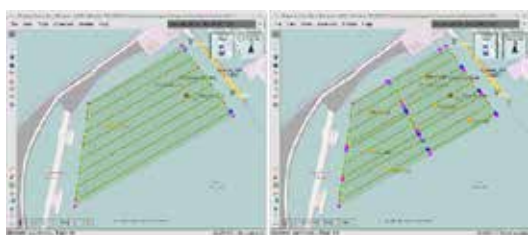
Fig. 4. Interface de operação baseada em Neptune. À esquerda zona a mapear definida pelo utilizador e, à direita, 6 sub-áreas resultantes calculadas pelo Neptune.
