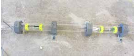
Fig. 4. Sensor de força e troço de emissário de medição.
