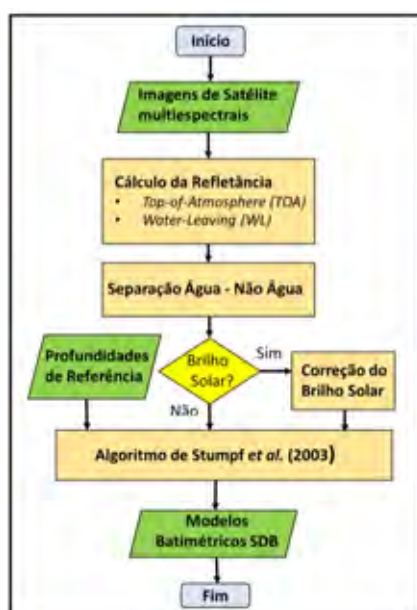
Fig. 1. Fluxograma da metodologia implementada na aplicação DeepInEye para a derivação de batimetria.
