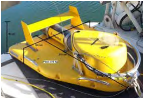
Fig. 2. Peixe do sistema combinado Chirp Sonar/Side Scan Sonar Edgetech SB-512i.
