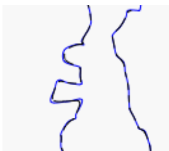
Fig. 8. Diferenças entre isobatimétricas criadas pelo Caris GIS (linha preta) e AutoCAD (linha azul). Os dois softwares, constroem a isobatimetria a partir da TIN.
