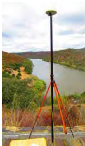
Fig. 2. Coordenação GNSS de um ponto de apoio.
