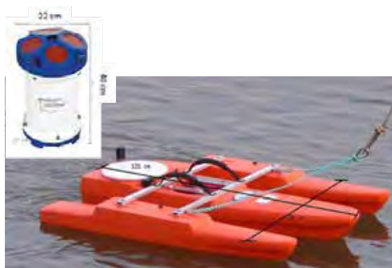
Fig. 4. Perfilador de corrente acústico ADCP WH Sentinel 1200 kHz e catamarã Riverboat Teledyne Ocean science.
