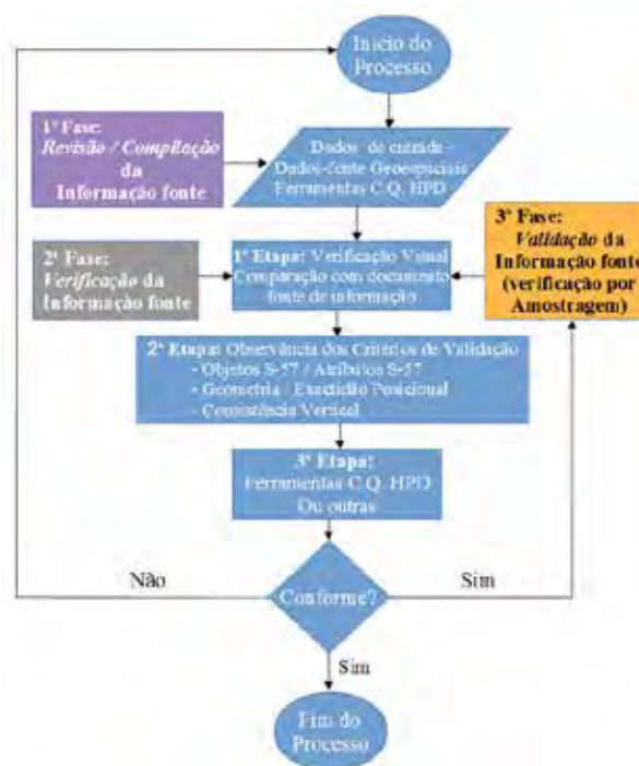
Fig. 4. Processo de CQ e validação dos dados – fonte no Sistema de Produção Cartográfica HPD
